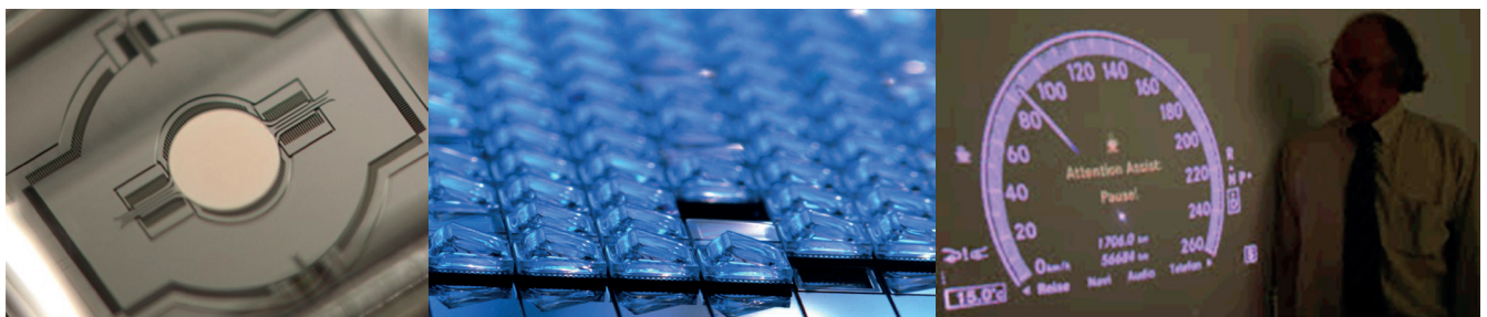
Abbildung 3: Links: Mikrospiegel aus Silizium; Mitte: seitliche Ansicht eines Silizium-Wafers mit Mikrospiegeln, die mit einem schrägen Glasdeckel im Waferverbund gekapselt wurden; Rechts: Tachometerdarstellung mit Hilfe eines Laserprojektionssystems, ©Fraunhofer ISIT
