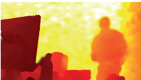
Abbildung 4: Abbildung einer Tiefenschätzung; Links: Tiefenbild mit Farbkodierung Hintergrund hell und Vordergrund dunkler, Rechts: Herausstellung der Personenumrisse in Echtzeit, ©Fraunhofer IGD
